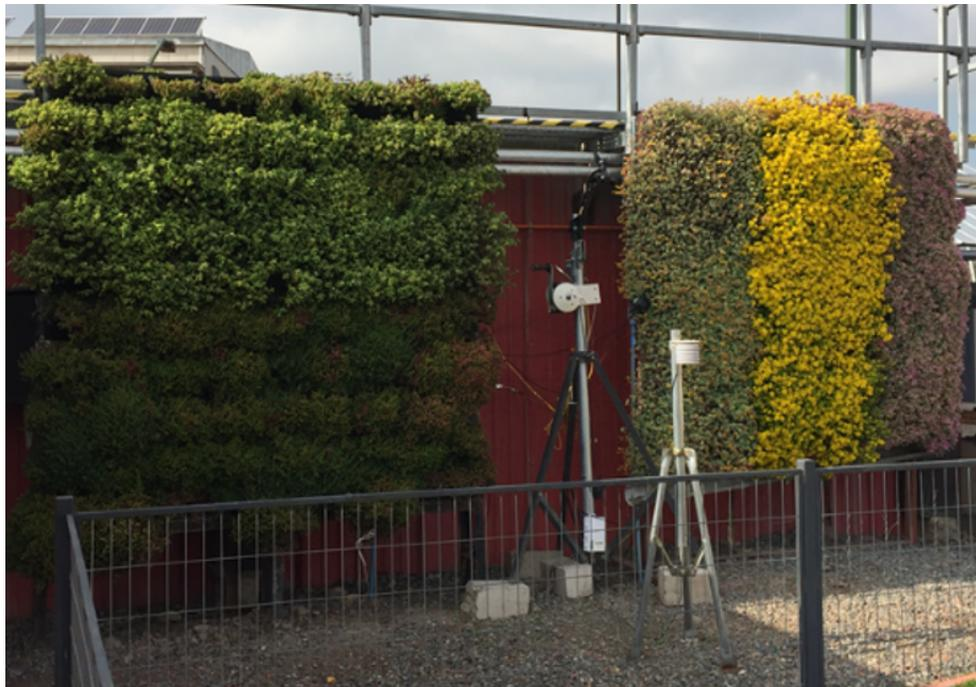
**Figura 1.11.** Ejemplo muro vegetativo en Laboratorio de Infraestructura Vegetal de Edificios (LIVE UC), Macul, Santiago, Chile.
